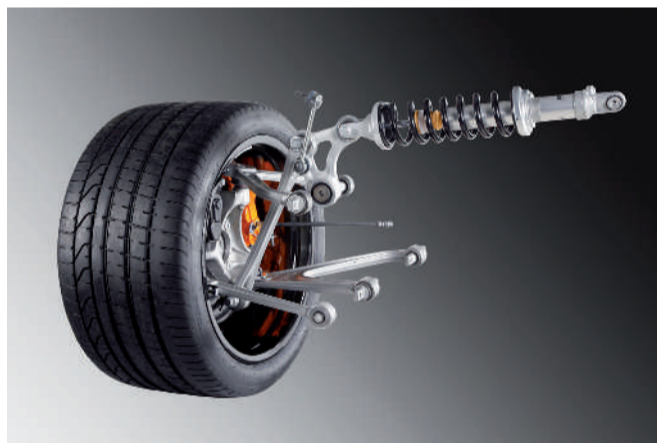
Kaiser-Lieferumfang Lamborghini Aventador für die Push-Rod Aufhängung mit 6 Bauteilen pro Achse
